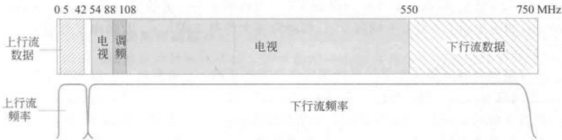
图 2-46 典型有线电视系统中用于 Internet 接入的频率分配
