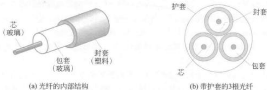
图 2-6 光纤的内部结构和带护套的 3 根光纤
