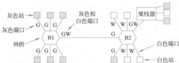
图 4-39 一个桥接 LAN 上的两个 VLAN
