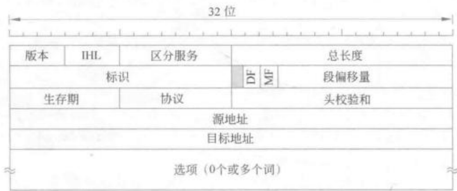
图 5-47 IPv4 头的格式
