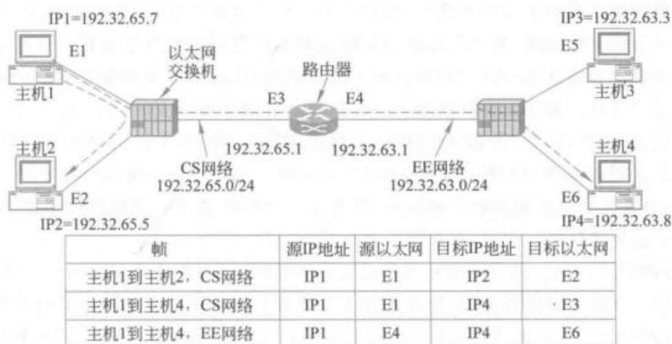
图 5-62 通过路由器连接两个交换式以太网 LAN
