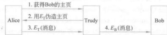
图 8-25 Trudy 暗中破坏公钥加密的一种方式
