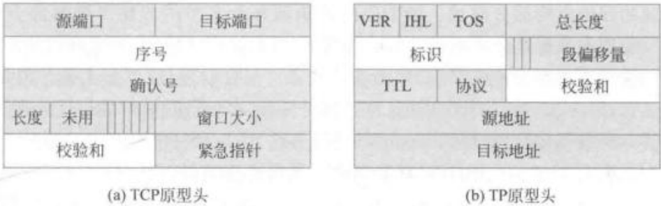
图 6-53 TCP 和 IP 的原型头
