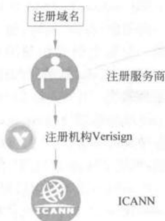
图 7-3 注册机构和注册服务商的关系
