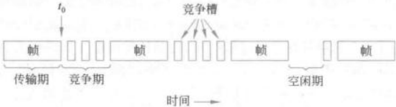
图 4-5 CSMA/CD 的简单模型
