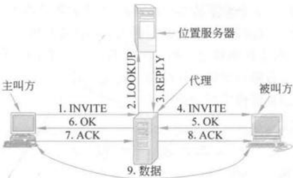
图 7-40 使用代理服务器和 SIP 重定向
