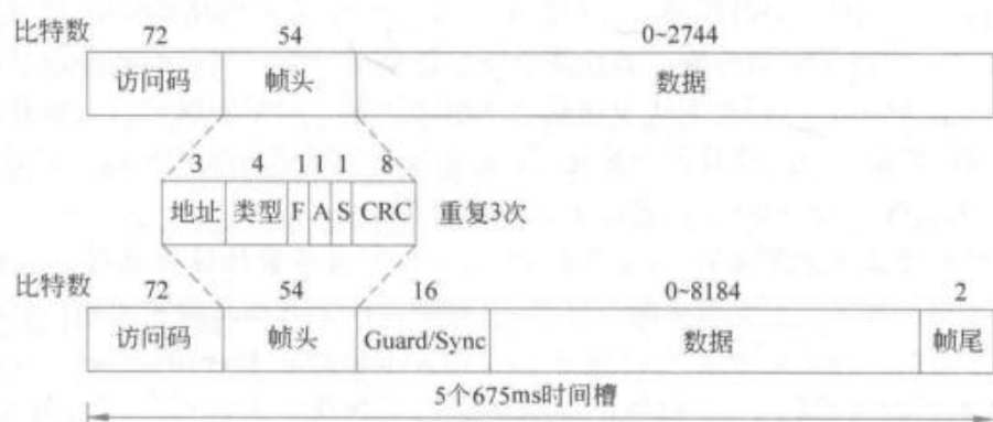
图 4-32 两种情况下的典型蓝牙帧结构
