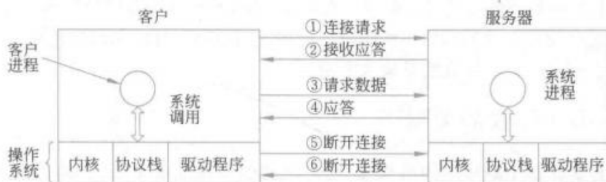
图 1-30 使用确认数据包的一个简单客户-服务器交互过程
