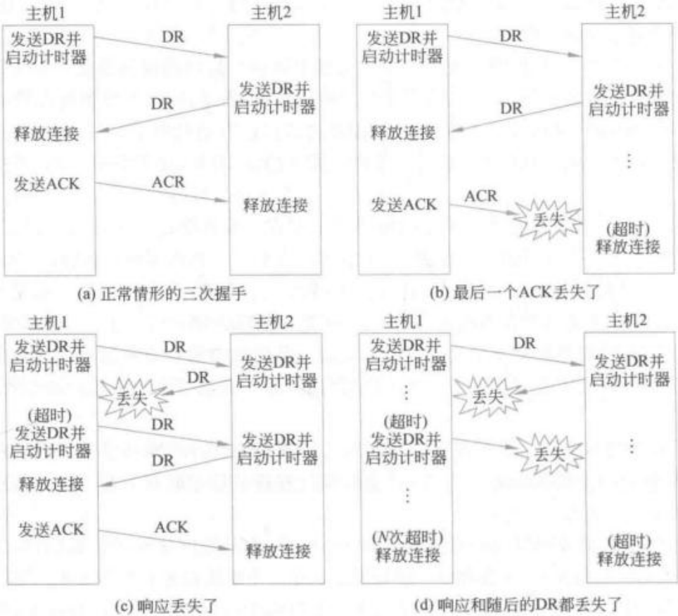
图 6-14 使用三次握手法释放连接的 4 个场景
