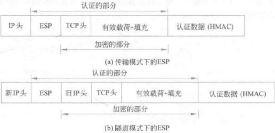
图 8-42 传输模式和隧道模式下的 ESP
