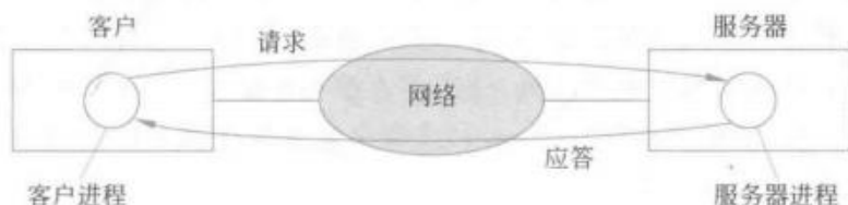
图 1-2 客户-服务器模型的请求和应答消息
