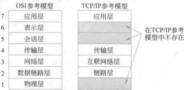
图 1-33 OSI 参考模型和 TCP/IP 参考模型各层的对应关系
