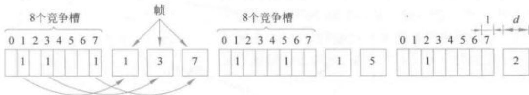
图 4-6 采用基本位图法的协议
