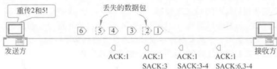
图 6-48 选择确认的工作原理
