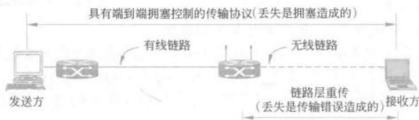
图 6-26 针对具有无线链路的路径的拥塞控制
