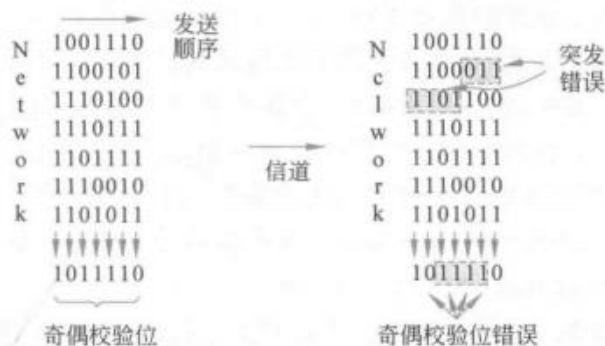
图 3-8 检测一个突发错误的交错校验
