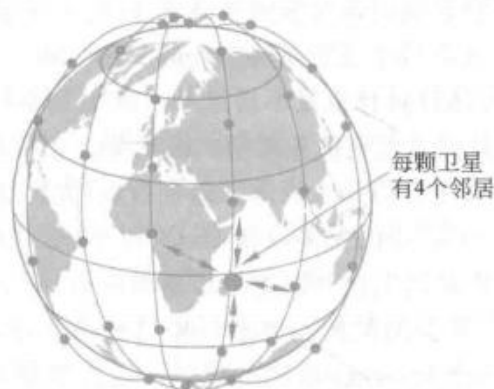
图 2-51 铱星卫星构成了围绕地球的 6 条项链
