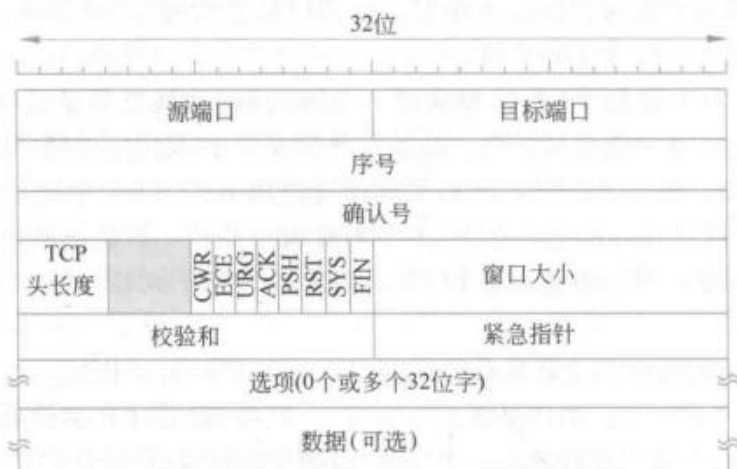
图 6-36 TCP 段的结构
