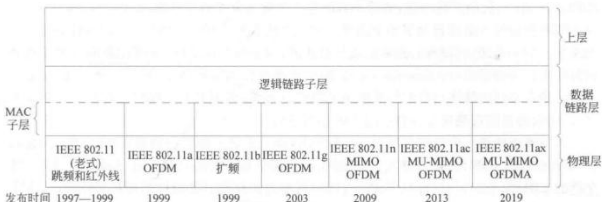
图 4-24 IEEE 802.11 协议栈的一部分
