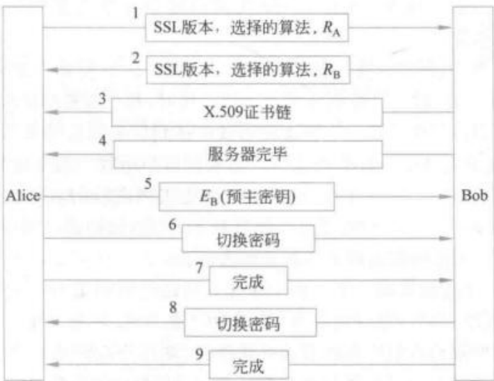
图 8-49 连接建立子协议
