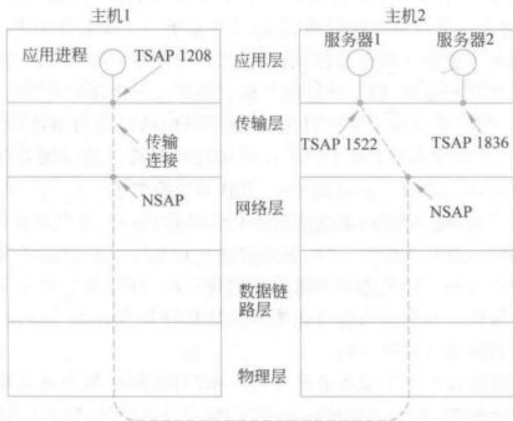
图 6-8 TSAP、NSAP 和传输连接之间的关系
