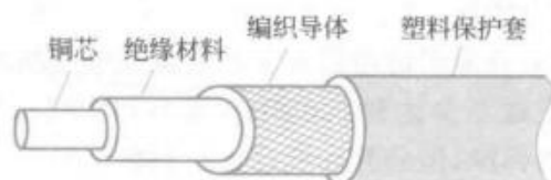
图 2-2 同轴电缆的结构
